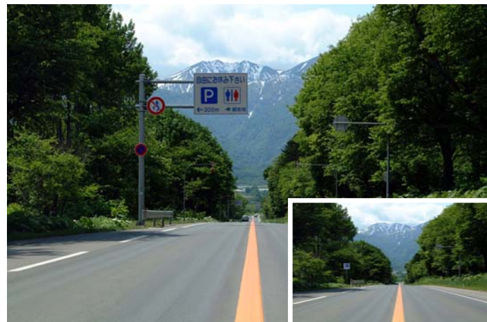
道路からの景観を阻害する標識 (右下は標識の縮小による改善後)
