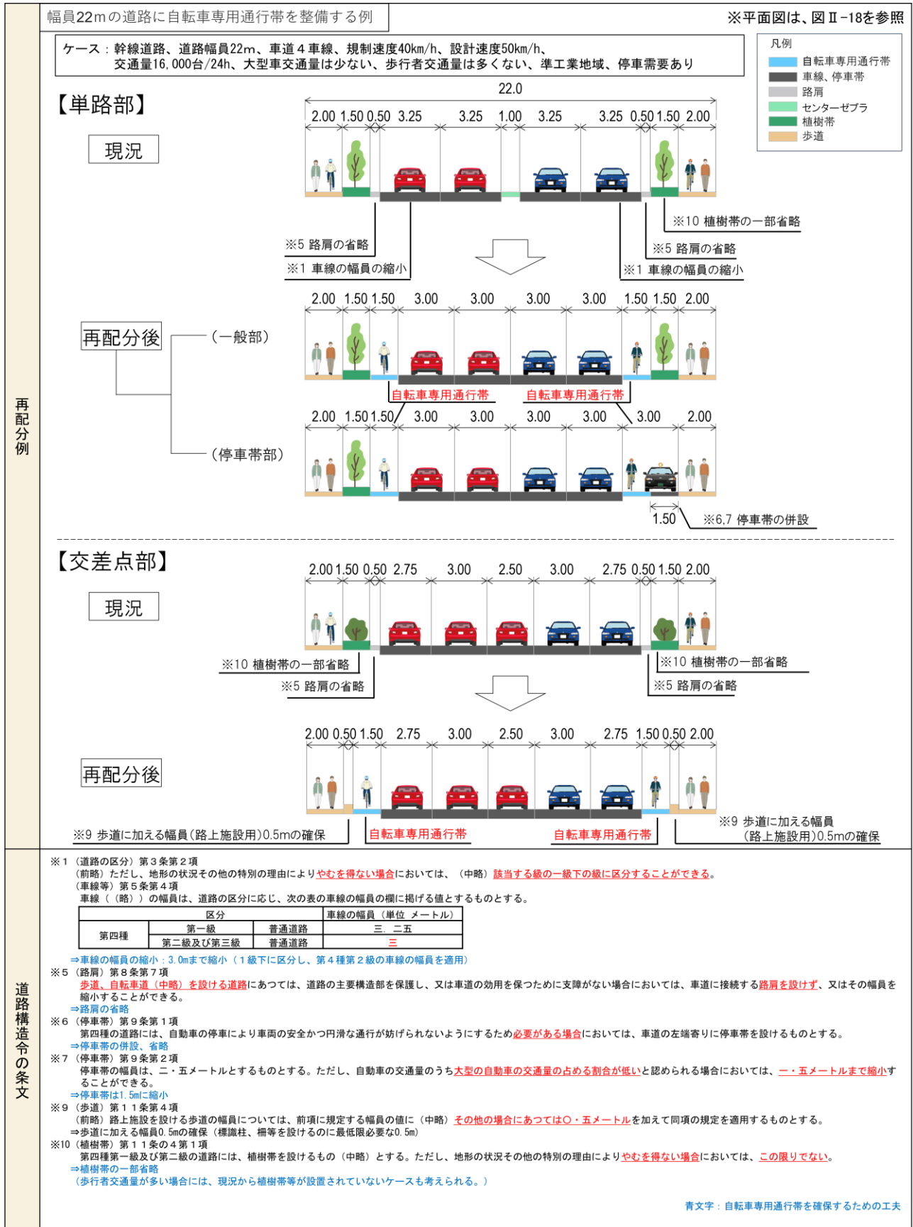
図 I-10 幅員 22m の道路において空間の再配分により自転車専用通行帯を確保する例
