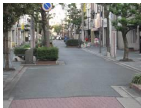
写真Ⅱ-11 自動車の速度を抑制するため、狭さくやシケインを設置した事例
