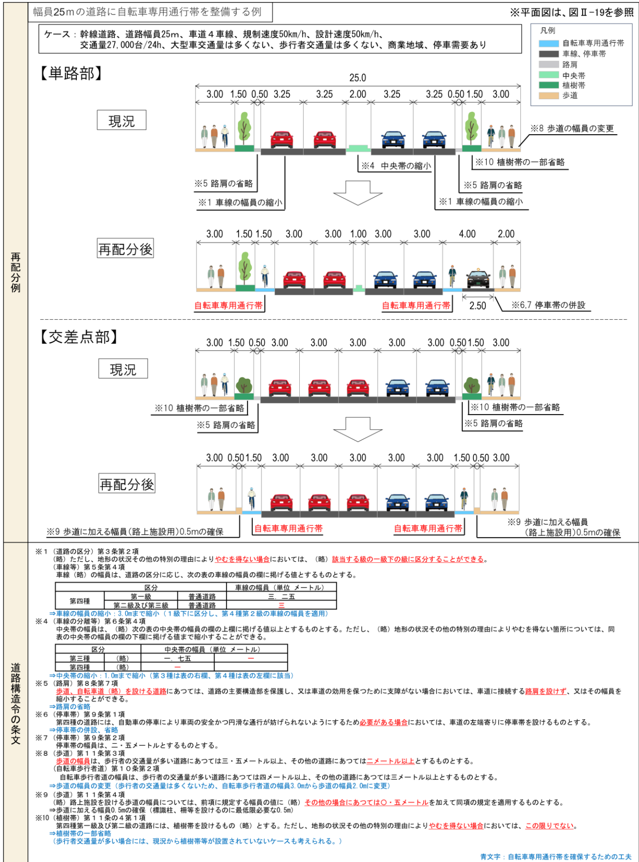
図 I-11 幅員 25m の道路において空間の再配分により自転車専用通行帯を確保する例
