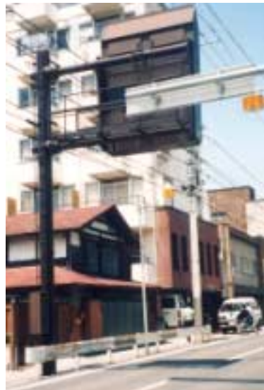
防護柵と照明柱、信号柱、標識柱の意匠、色彩が異なるため、煩雑な印象となっている例
