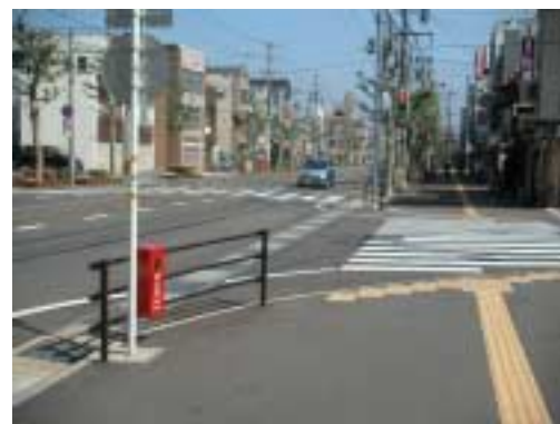
交差点内での歩行者等の乱横断防止柵のために設置された防護柵は、ポラードとチェー ンの組み合わせで代替可能
