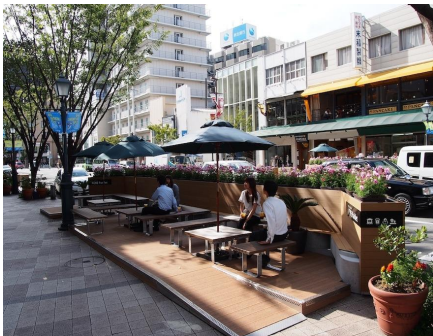
写真 2-1-18 パークレットによって歩行空間との段差を設けることによる誤進入の防止 (兵庫県神戸市)
