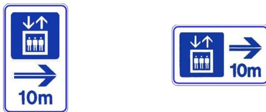
図 2-7-3 エレベーターの設置場所までの距離を表示した例
