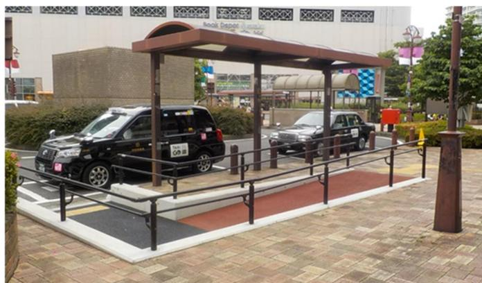
写真 2-7-12 車椅子使用者を対象としたタクシー乗降場のスロープ設置
