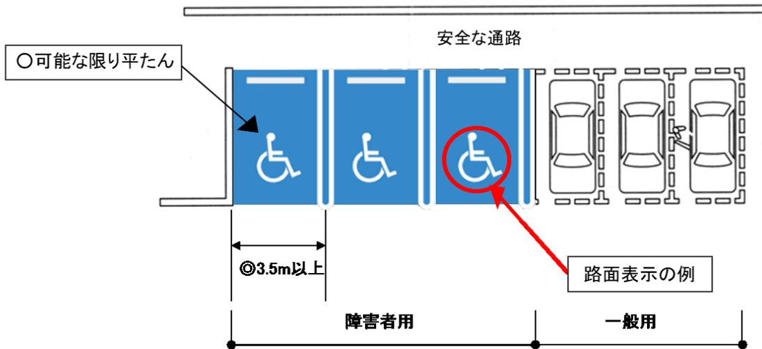
図 2-5-1 障害者用駐車施設の構造の例
