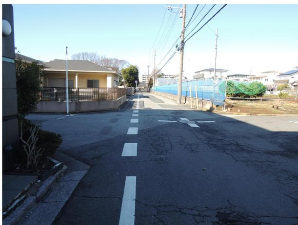
写真 2-1-24 単断面道路の交差点の車道外側線
