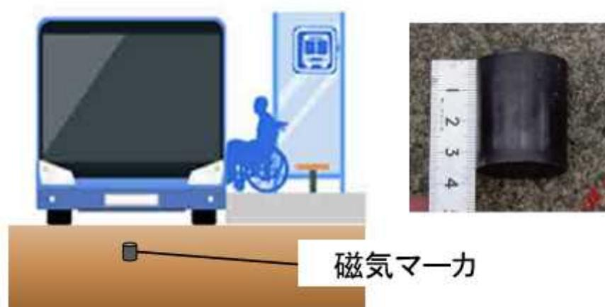
図 2-3-1 磁気マーカを活用した自車位置補正による運行の補助
