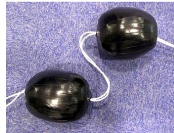
図 共用FA管・1管セパレート用試験器（例）
