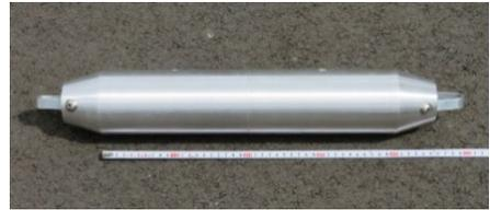
図 通信管路用試験器（例）
