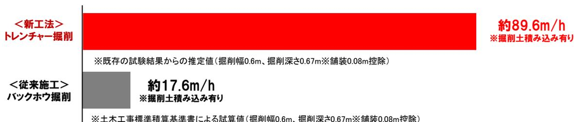
図 トレンチャーとバックホウの掘削速度の比較
