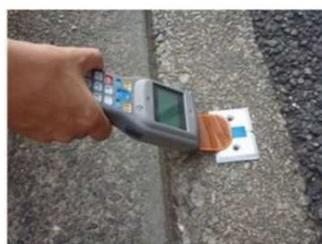
図 IC タグ（地上設置型）
