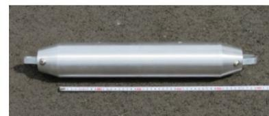
図 電力管路用試験器(例)
