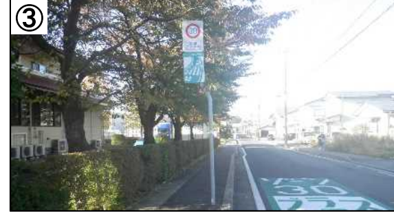
30km/h規制標記、ゾーン30プラス看板・路面表示
