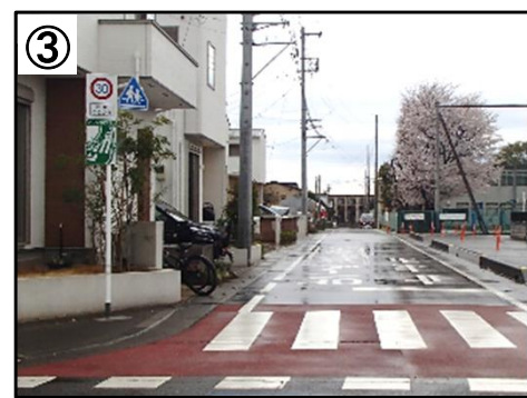
ゾーン30プラス看板・路面表示
