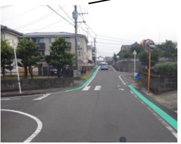
グリーンベルトを設置
