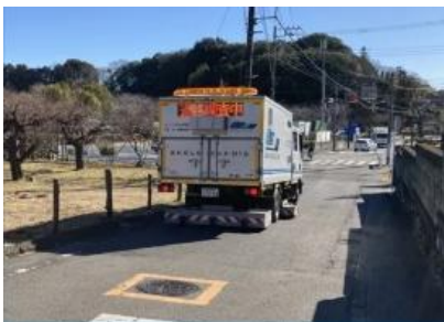
(空洞探査車による調査)
