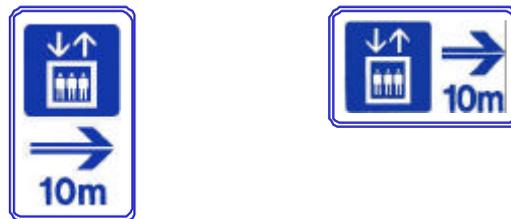
図 7-2-2 エレベーターの設置場所までの距離を表示した例
