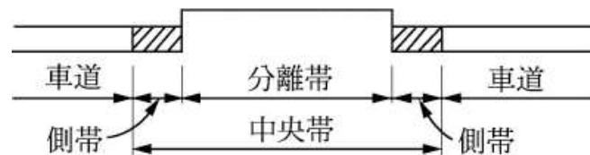
図 中央帯における側帯の構造
