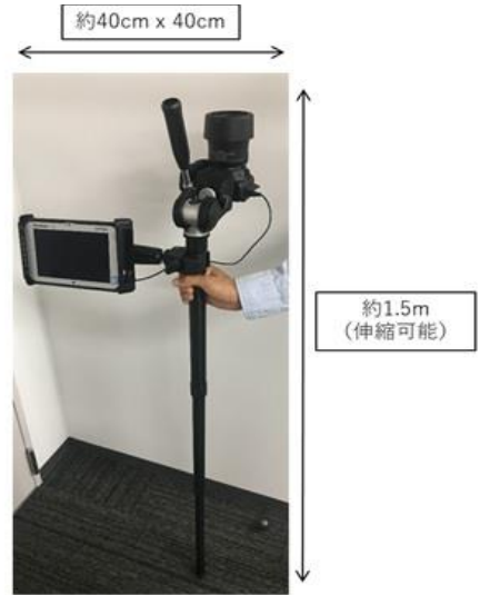
構成例 (一脚、パナソニック タフパッドFZ-M1、タブレットホルダー)
