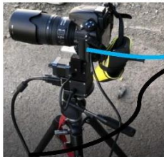
デジタルカメラ Nikon D850 300mm望遠レンズ使用 自動首振り雲台
