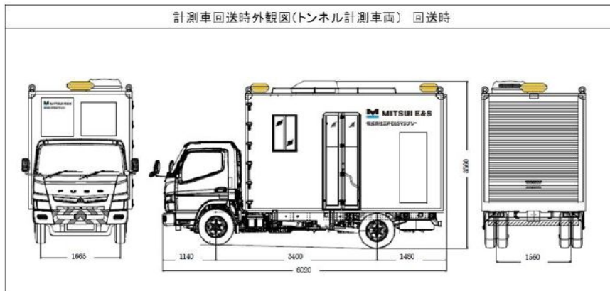
計測時は後部シャッターが開いて照明ユニット、撮影ユニットが後方に張出す(600mm程度)
