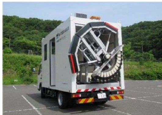
計測時は後部シャッターが開いて照明ユニット、撮影ユニットが後方に張出す(600mm程度)
