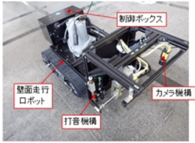
装置概要 長さ1000mm×幅530mm×高さ630mm
