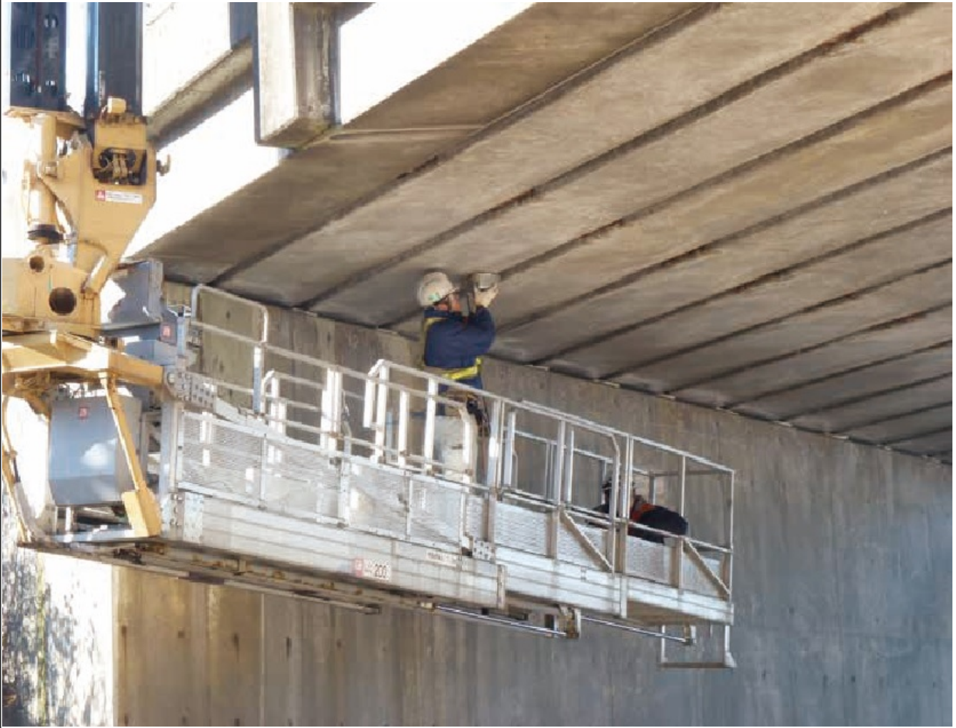
図3 コンクリートビューの測定例
