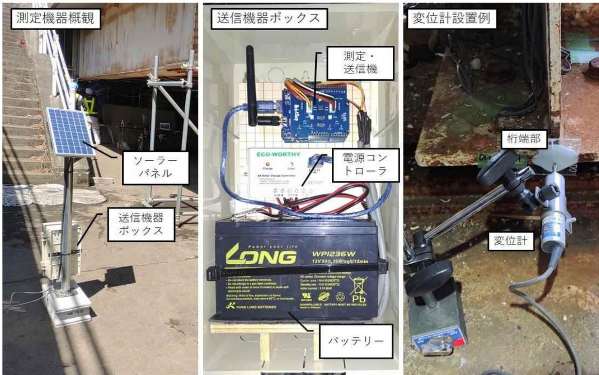
支承近傍にソーラパネル及び送信機器ボックスを設置。桁端部に変位計設置 (橋軸方向測定)
