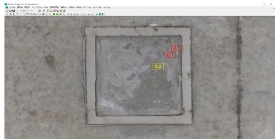
Step-3:画像上でひびわれをプロットして幅測定
