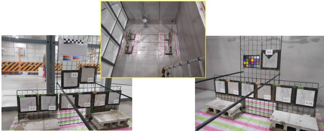
写真-1:ひびわれ模擬パネル(15パネル)+カラーチャート2枚
