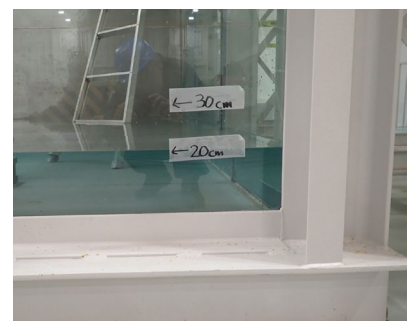
写真-3 注水(H=0.20 m)完了
