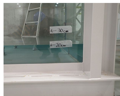
写真-3 注水 (H=0.20 m) 完了
