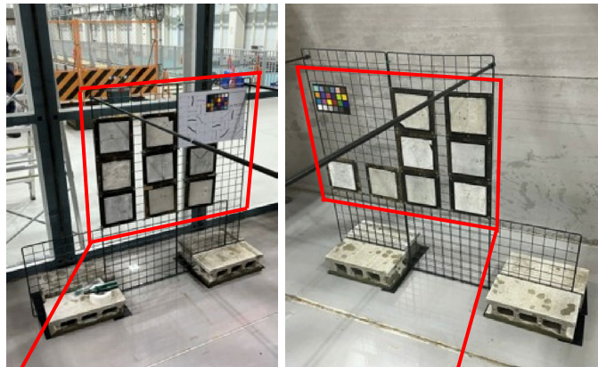
写真-2 供試体とカラーチャートの設置
