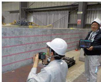
写真-7 電磁波探査器(小)
