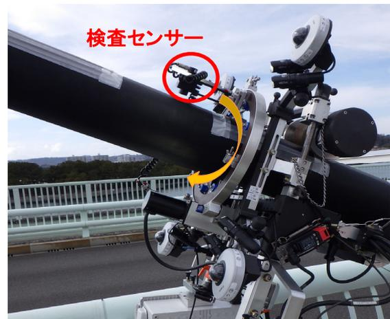
検査範囲300mm間を1cmピッチで計測しながら移動
