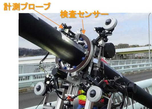
計測プローブ 検査センサー
