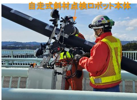
自走式斜材点検ロボット本体
