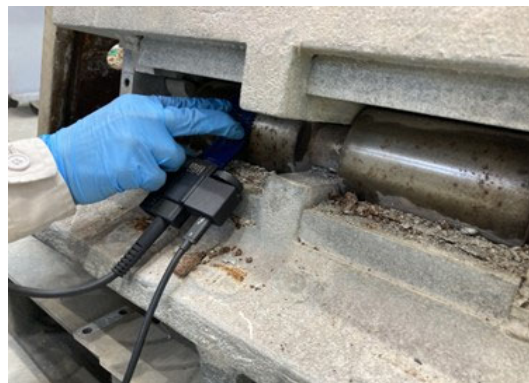
ET調査の実施状況(別の実橋サンプルでの実施イメージ)
