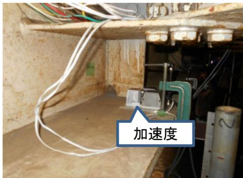
写真-5 加速度計による測定
