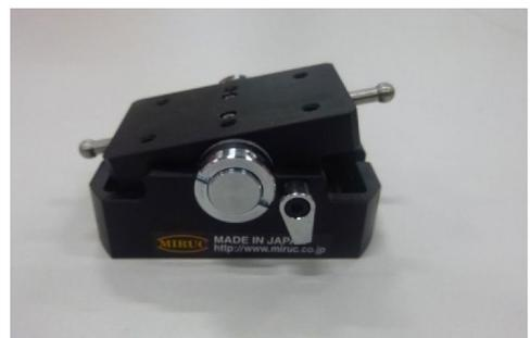
写真-2 傾斜架台
