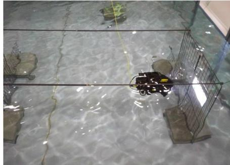
水中で、停止し、水流を発生した状態での移動量を確認する。
