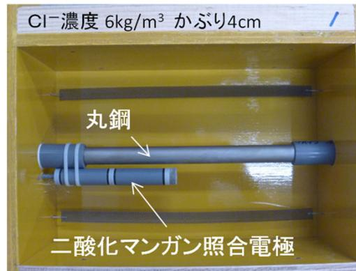
鋼材と埋設MnO<sub>2</sub>電極
