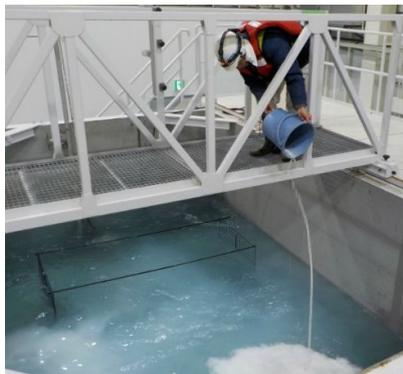
写真-12 濁度材(カオリン)投入状況
