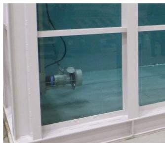
写真-13 流速装置(攪拌機)
