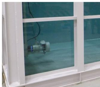
写真-13 流速装置(攪拌機)
