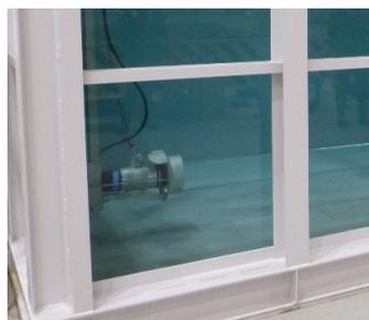
写真-13 流速装置(攪拌機)
