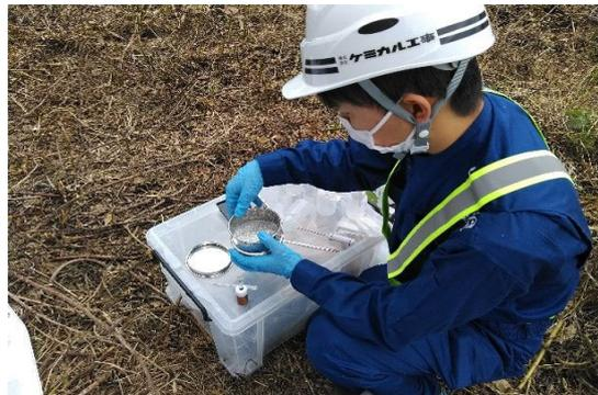
写真-2 600 $\mu$ mふるいにて粒度調整
