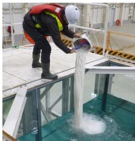
写真-12 濁度材投入状況
