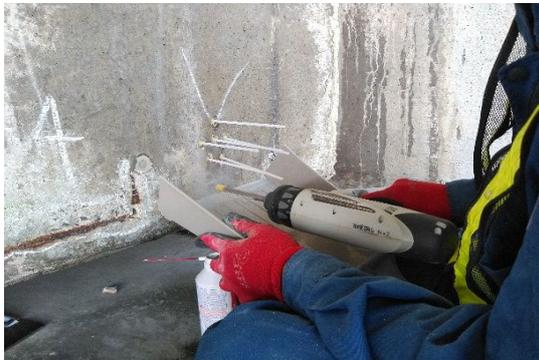
写真-1 ドリル削孔による試料採取
