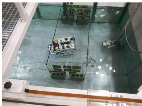
水中で、停止し、水流を発生した状態での移動量を確認する。
