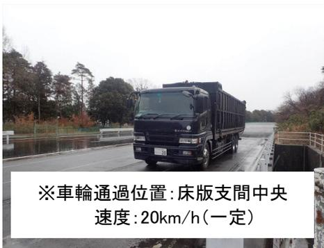
※車輪通過位置: 床版支間中央 速度: 20km/h(一定)
