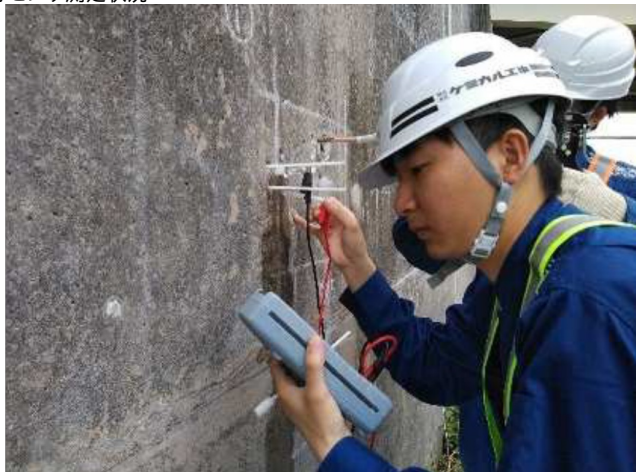
図1 接触法の測定状況
