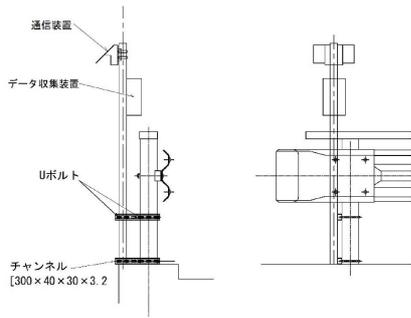
データ収集・通信装置機設置例
