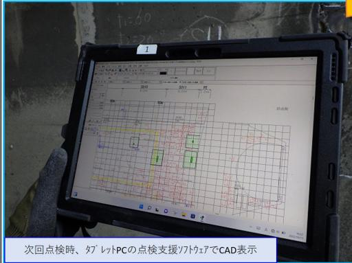
次回点検時、タブレットPCの点検支援ソフトウェアでCAD表示
