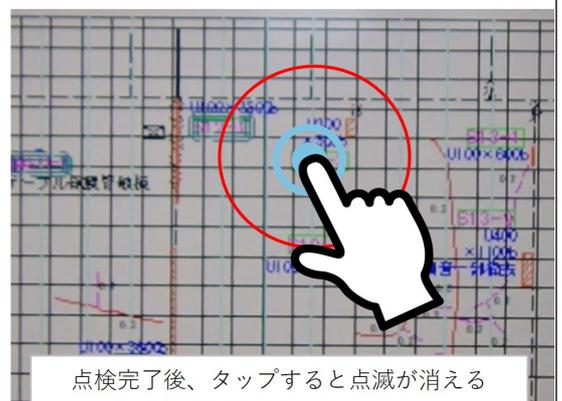
点検完了後、タップすると点滅が消える
