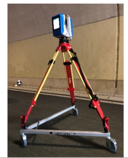
3次元レーザースキャナセッティング状況
