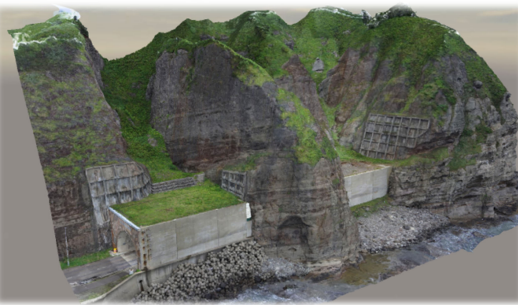
【技術紹介動画】 空中写真測量を使ったトンネルの3Dモデル化「隧道SfM/MVS技術」 (Structure from Motion/Multi View Stereo)
