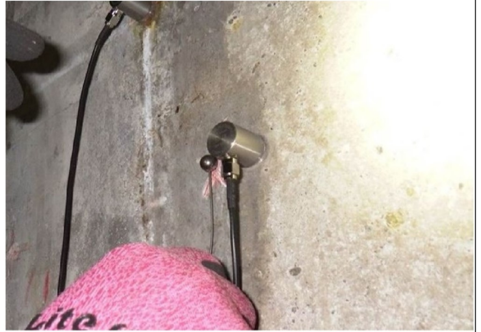
鋼球による打撃
