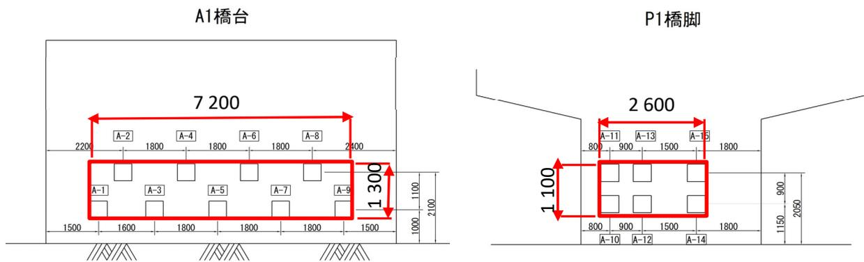
撮影面積(7.2×1.3+2.6×1.1=12.22m<sup>2</sup>)を移動して、撮影に要した時間(秒)を計測する。
