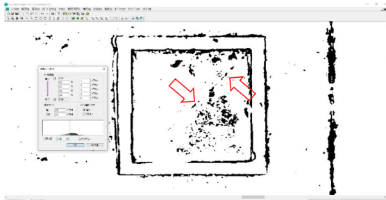
Step-2:二値化処理によるひびわれ抽出
