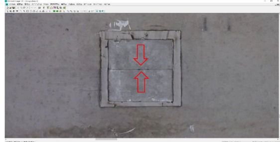
Step-1:オルソ画像上でひびわれ確認
