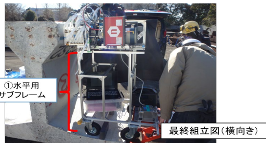
写真4-1: 計測機材の名称と最終組立図(上向き用)
