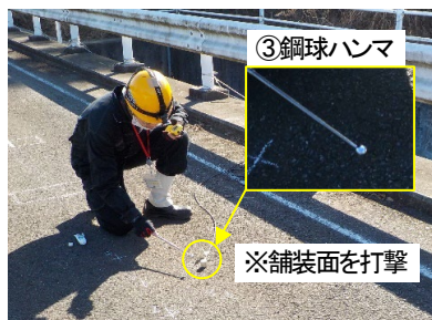
写真-8 鋼球ハンマにより舗装面打撃
