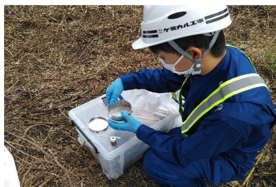
写真-2 600 \mu mふるいにて粒度調整
