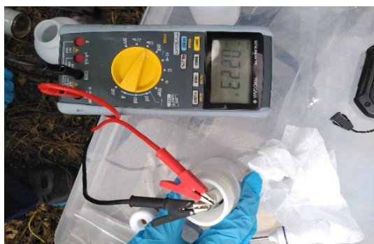
写真-5 電位差の測定状況
