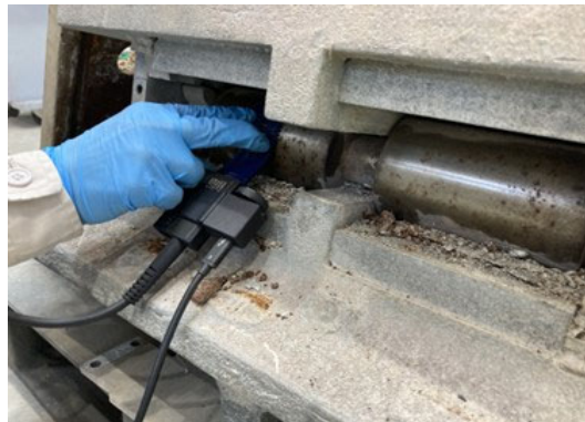
ET調査の実施状況(別の実橋サンプルでの実施イメージ)
