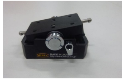
写真-3 傾斜架台
