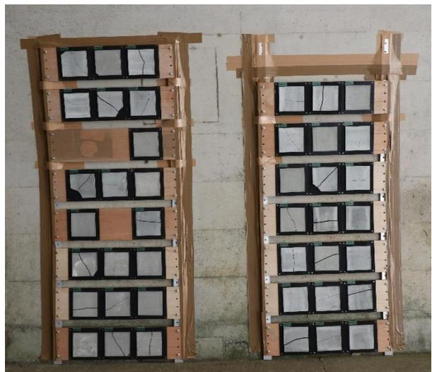
図3.現場写真(ひび割れ供試体)
