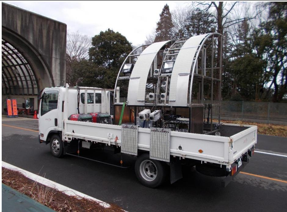
図3.走行型トンネル撮影システム
