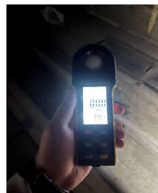
坑内照明なし
