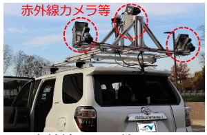
赤外線カメラ等による コンクリート床版の点検
