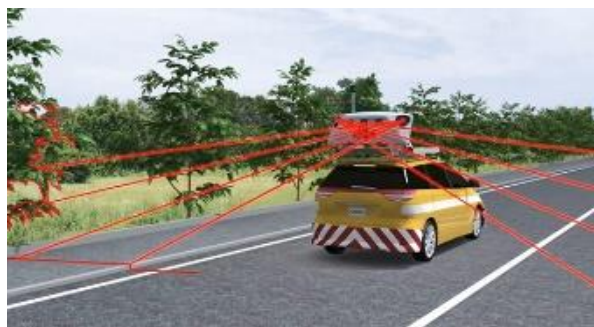
計測車両MMSによる計測状況
