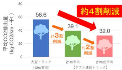
ダブル連結トラック活用によるCO 2 削減効果 (千ト・km当たりの排出量)
