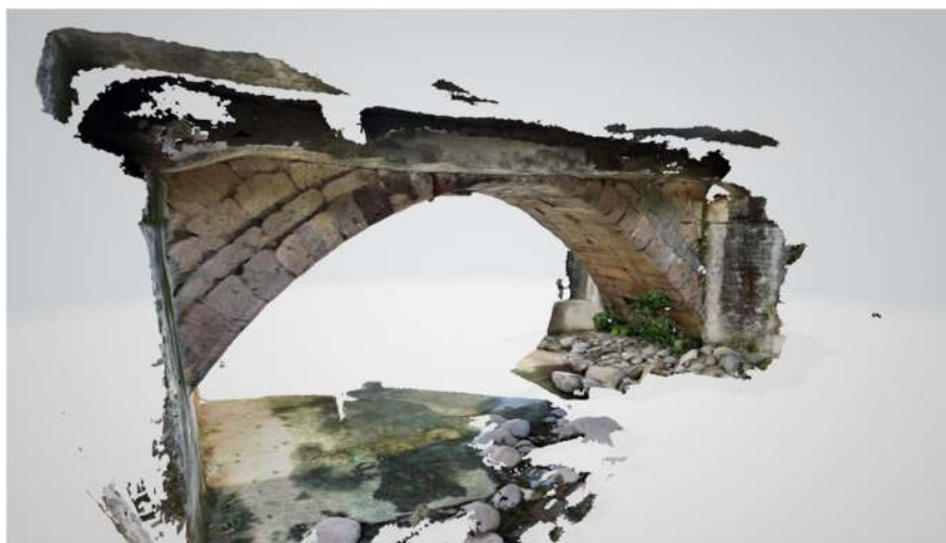
図-2.7 モバイル端末の三次元形状を計測するアプリを用いて三次元データを取得した事例
