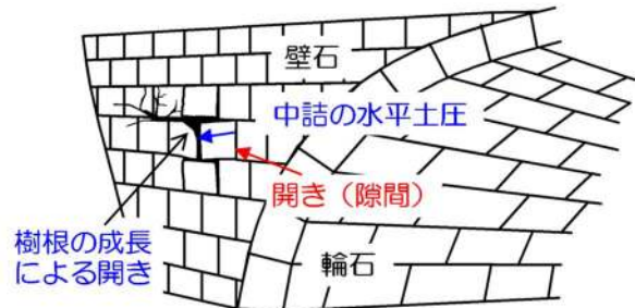
開き（隙間）のイメージ図
