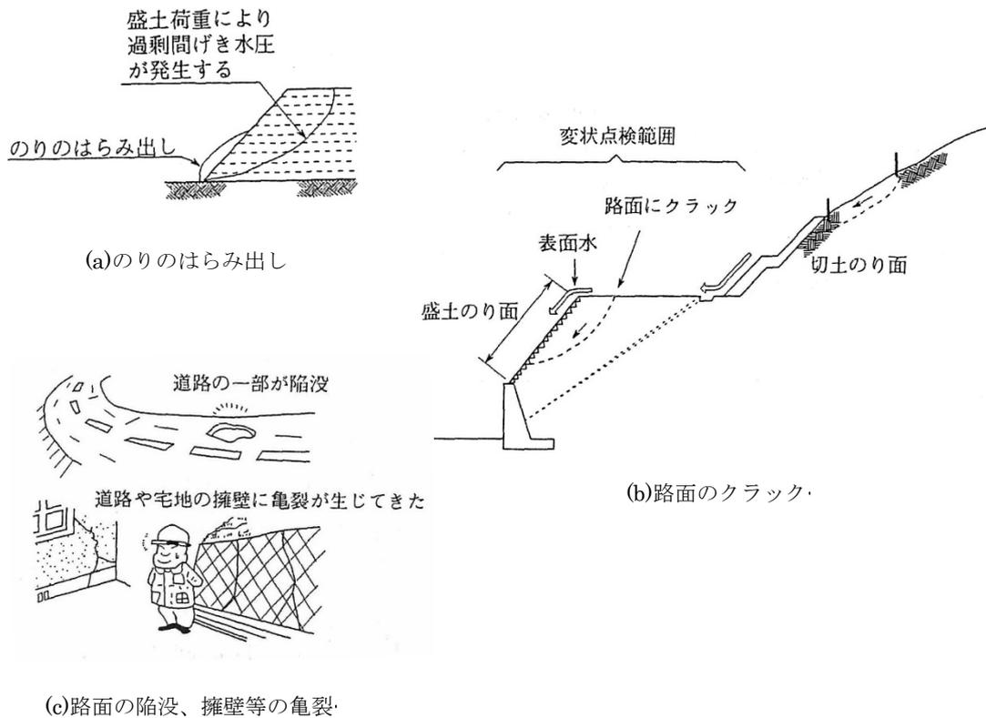
図-2-7 構造的な変状の例
