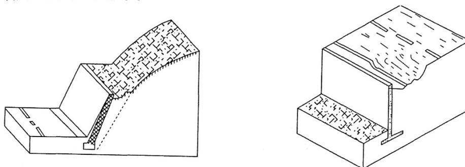
図-2-18 背面の陥没・沈下
