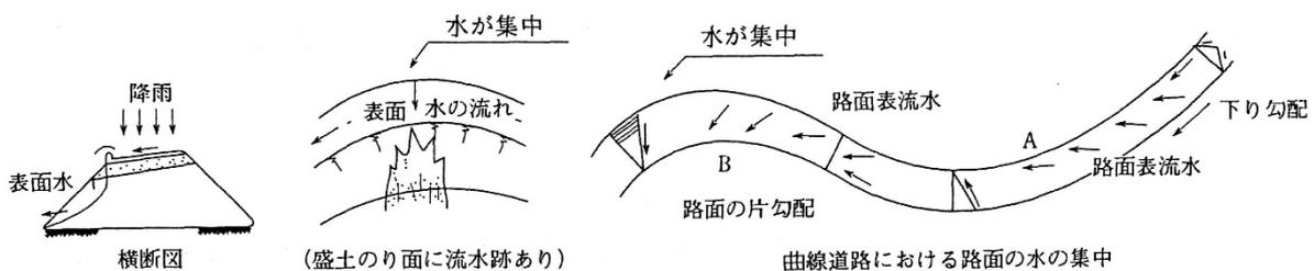
図-2-10 路面の水の集中とのり面の変状
