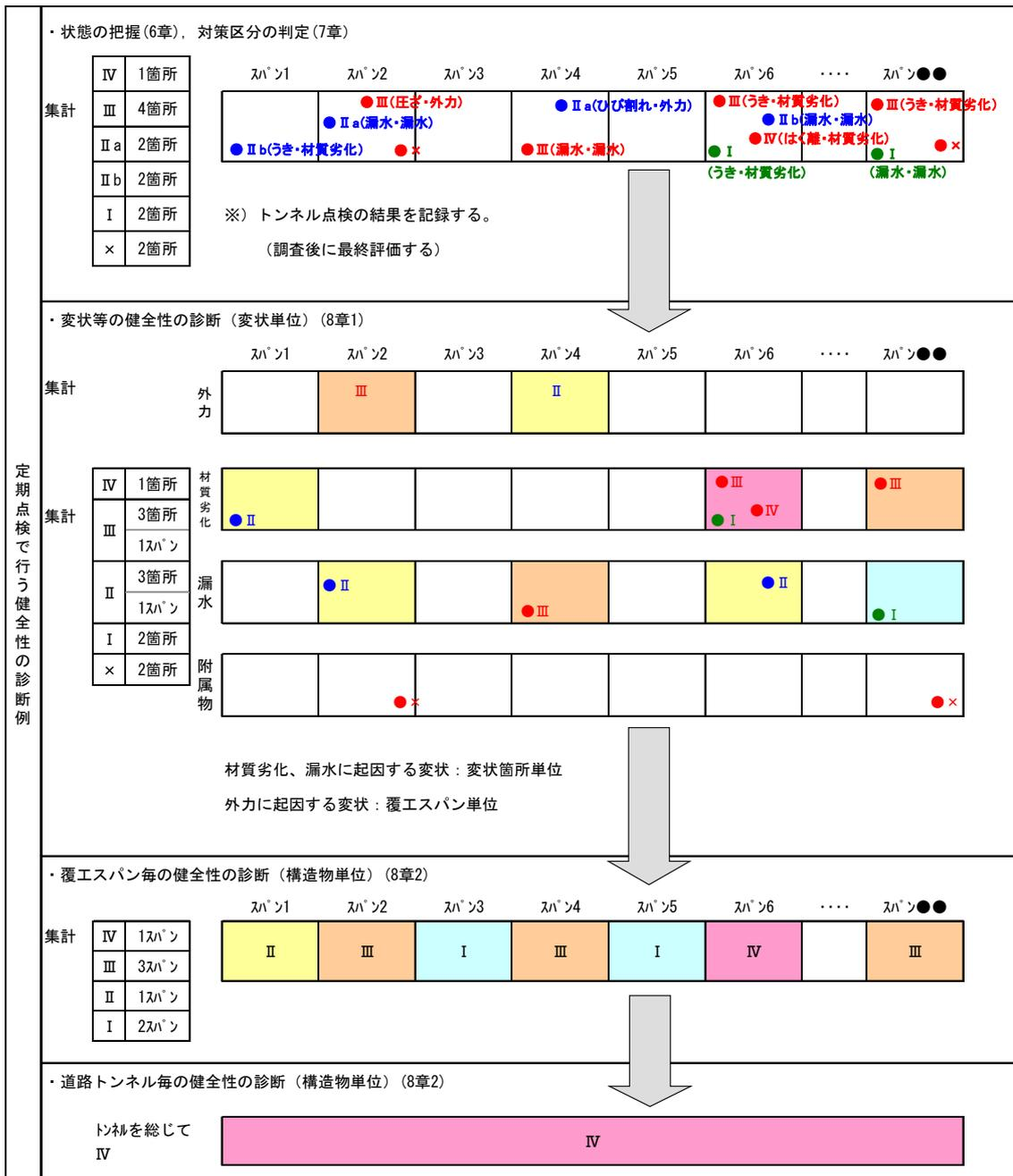
図-解 8.1 健全性の診断の流れの例
