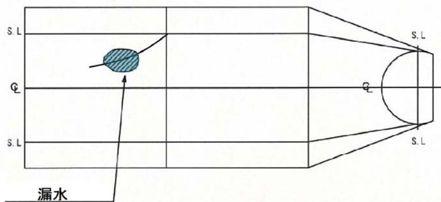
付図-1.9 ひび割れからの漏水位置の例
