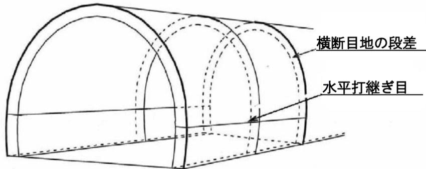
付図-1.10 目地部、打継ぎ目部の段差の例
