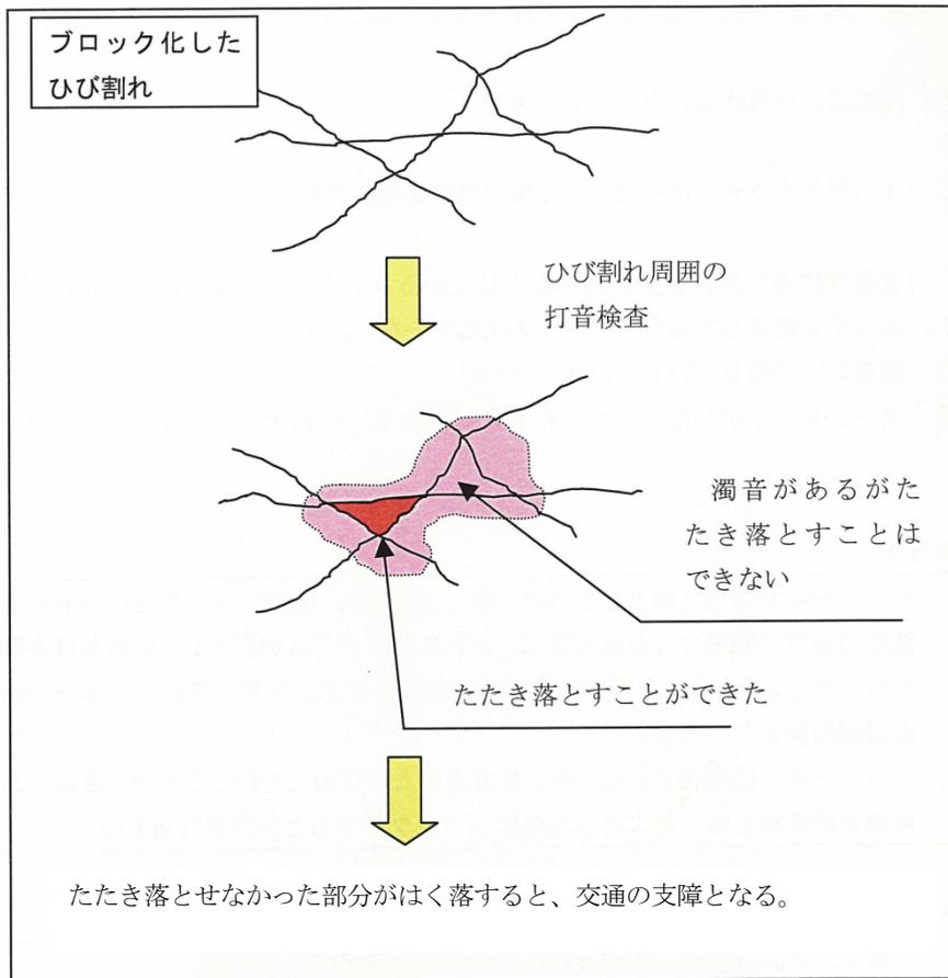
付図-2.1 ブロック化したひび割れの例
