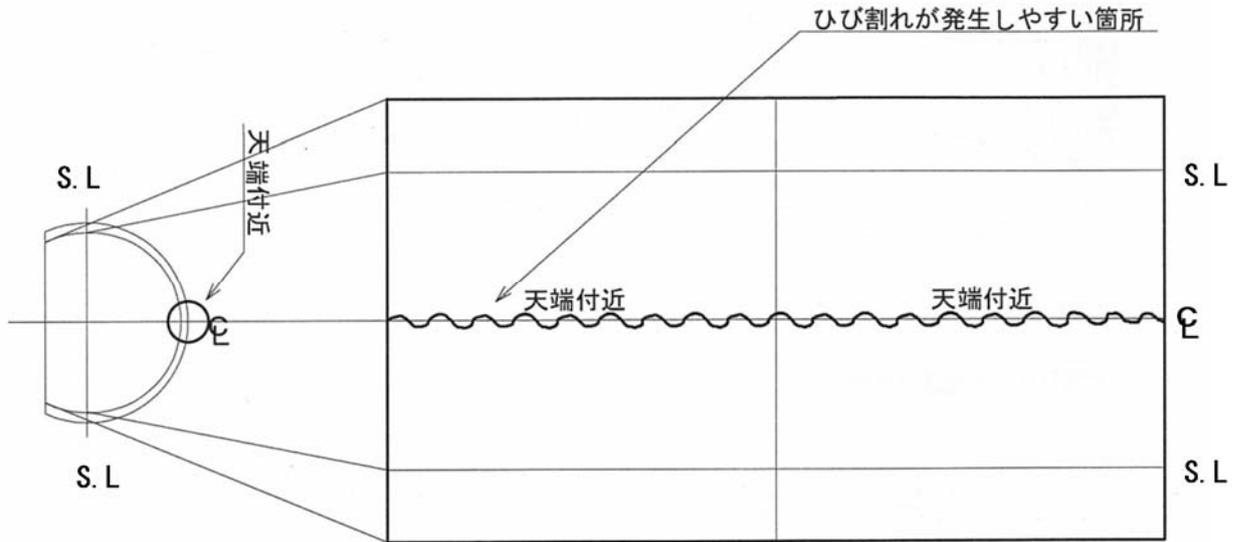
付図-1.4 覆工の天端とその付近に発生する変状の例
