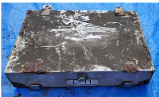
照明灯具の背面（取付脚の腐食）
